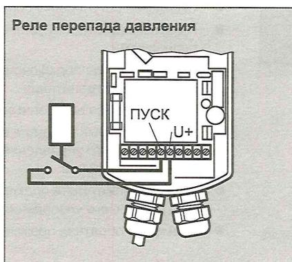
Функцией обратной промывки можно по мере необходимости управлять при помощи реле перепада давления DDS 76 с микропреключателем, имеющим "сухие" контакты. Рекомендуется устанавливать перепад давления на уровне 1,0 бар.
