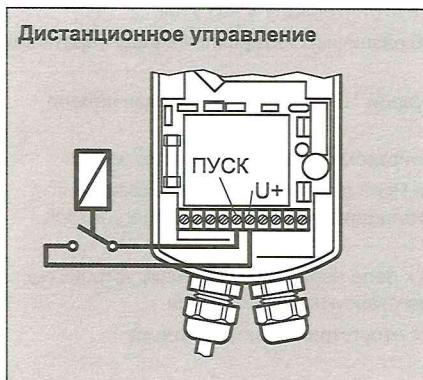
Приводом Z 11 AS можно управлять дистанционно при помощи реле с перекидными "сухими" контактами (например, реле Honeywell Centra типа REL 2). Минимальное время удержания контактов реле для активизации обратной промывки составляет одну секунду.
